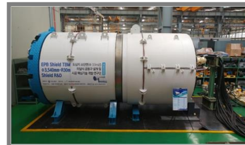
공동구 급곡구간 시공장비
