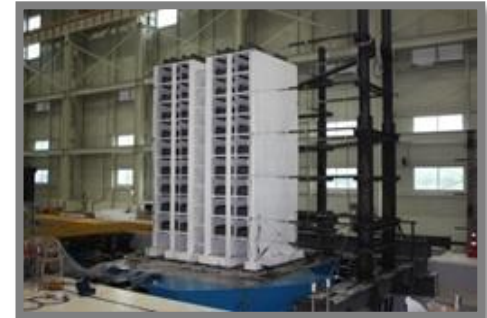
연구장비 인프라 : 공동주택모형 내진성능 시험
