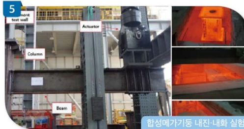
합성메가기둥 내진-내화 실험 재료바-공기단축 등이 가능한 내부보강조립식 합성메가기둥
