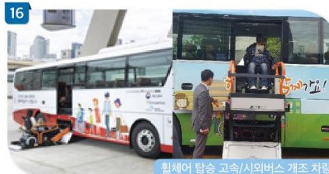
16 휠체어 사용자 탑승가능한 고속/시외버스 차량 휠체어 탑승 고속/시외버스 개조 차량
