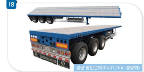
18 경량 평판 트레일러 및 접이식 경량 롤컨테이너 경량 평판컨테이너(1.2ton 경량화)
